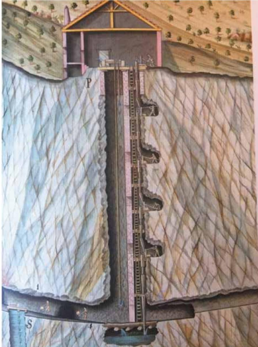
Figura 3. *CORTE TRANSVERSAL DE UN POZO DE LA MINA DE LA CONCEPCIÓN (ALMADENEJOS), CON LAS MÁQUINAS ASPIRANTES PARA DESAGUAR, LAS ESCALERAS PARA LA BAJADA DE LOS MINEROS Y UN TORNO PARA SUBIR Y BAJAR HERRAMIENTAS Y MINERALES.*
