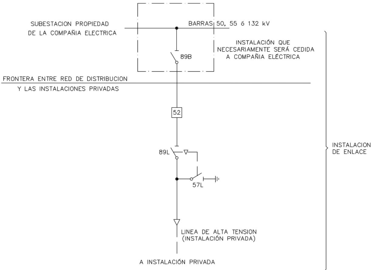
**Esquema 1:** Conexión directa mediante Línea AT a Barras de Subestación ( $50 \text{ kV} \leq V_n \leq 132 \text{ kV}$ ).
